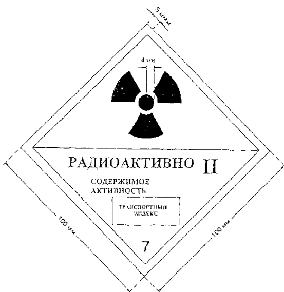
Рис. 6. Информационное табло: указаны минимальные размеры, при использовании больших размеров следует сохранять указанные пропорции; высота цифры «7» должна быть не менее 25 мм; цвет фона верхней половины табло — желтый; нижней половины — белый; цвет основного знака радиационной опасности (трилистника) и надписи — черный; использование слова «РАДИОАКТИВНО» в нижней части необязательно, что позволяет применять это табло для изображения соответствующего номера ООН для груза.
