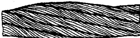
Рисунок 13. Местное увеличение диаметра каната
