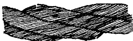
Рисунок 1. Обрывы и смещения проволок каната крестовой свивки
